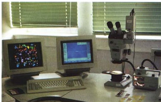
Il sistema VIDAS di acquisizione, elaborazione ed analisi dell'immagine della Zeiss - Kontron è utilizzato prevalentemente per la misura delle impronte delle gocce su cartine idrosensibili nello studio della qualità della distribuzione di macchine per i trattamenti fitofarmaceutici.
